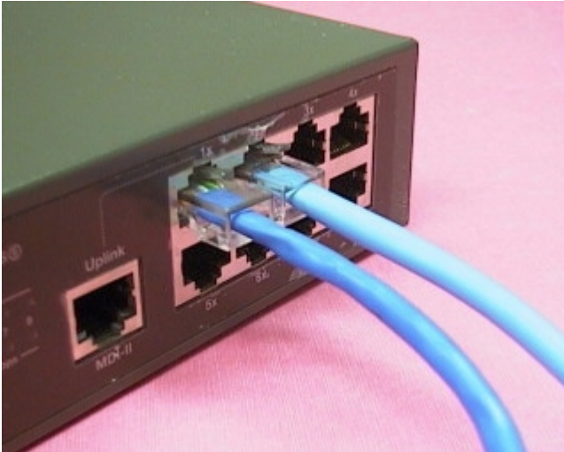
Figura 10 Detalhe da conexão dos cabos no hub.
